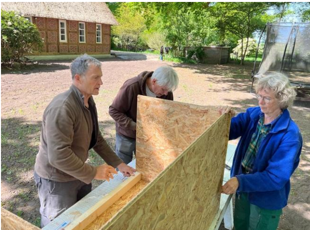
Mitglieder der Eulenschutzgruppe Lilienthal beim Bau eines Nistkastens für Schleiereulen in Überhamm. Der Kasten wurde aus OSB-Platten erstellt und hat eine Größe von ca. 120 x 70 x 70 cm. (Foto: G. Geier)
